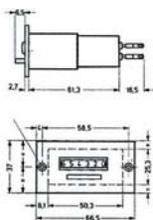
Tipo da incassare, con fissaggio a vite.
